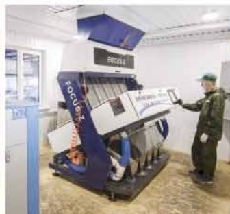
Работают две линии очистки семян с использованием оптических сортировщиков, которые позволяют добиваться 99,9% чистоты продукта.
