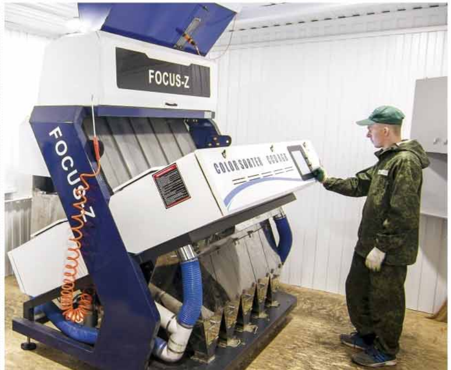
Финальная стадия очистки семян производится с использованием трех оптических сортировщиков, которые позволяют получить чистоту посевного материала 99,9%.
