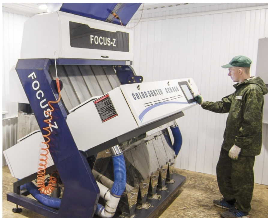
Для качественной очистки семян работают три семенные линии с оптическими сортировщиками, что позволяет добиваться 99,9% чистоты продукта.
