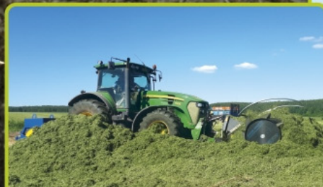
Распределитель силоса и сенажа RECK JUMBO II
