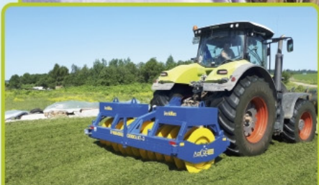
Трамбовщик силоса и сенажа КТ-3ЈЕСК и ЈЕСКМАХ
